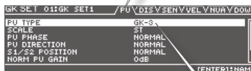
Usate i tasti cursore [▲] [▼] per selezionare il parametro da modificare, e usate la manopola per modificare il valore del parametro.
