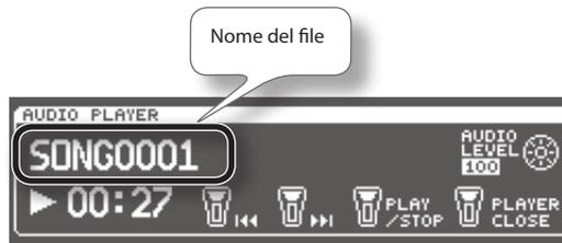
2. Usate il cursore per selezionare il nome del file, e ruotate la manopola per scegliere il file che volete riprodurre.
