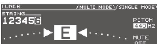
\* Nel parametro SYSTEM GK SETTING (p. 69), se DOWN TUNE è regolato su un valore diverso da "0," la schermata dell'accordatore indica il nome della nota come se non fosse accordata più bassa.
