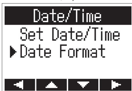
3. Usate  <sup>LOCUT</sup> e  <sup>LIMITER</sup> per selezionare il formato della data, e premete  <sup>AUTOLEVEL</sup>.
