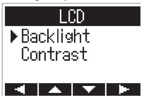
3. Usate  <sup>LOCUT</sup> e  <sup>LIMITER</sup> per impostare la quantità di tempo dopo la quale la retroilluminazione si spegne, e premete  <sup>AUTOLEVEL</sup>.
