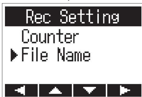
3. Usate  <sup>LOCUT</sup> e  <sup>LIMITER</sup> per selezionare il formato del nome del file, e premete  <sup>AUTOLEVEL</sup>.
