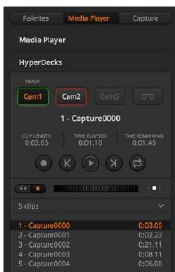
最多可选择四台HyperDeck，只要点击HyperDeck面板中对应的选择按钮即可
