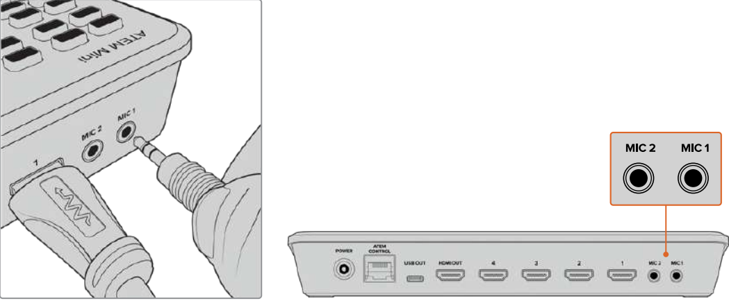
Conecte los micrófonos a las entradas correspondientes en el mezclador.
