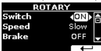
3. Per aggiungere l'effetto Rotary, usare i bottoni [▲], [▼] per selezionare il parametro "Switch" ed usare la manopola [DATA ENTRY] o i bottoni [◀] [▶] per impostare "ON".
