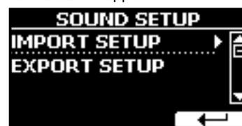
3. Usare la manopola [DATA ENTRY] o i bottoni [▲] [▼] per selezionare la funzione "IMPORT SETUP" e premere il bottone [▶] per accedere alla funzione.
