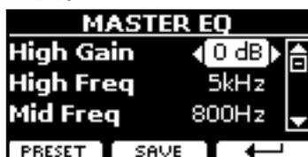
2. Usare la manopola [DATA ENTRY] o i bottoni [▲], [▼] per selezionare il parametro e usare i bottoni [◀][▶] per regolare il valore.
