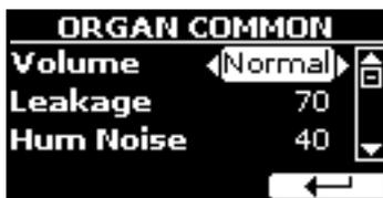
3. Usare i bottoni [▲], [▼] per selezionare il parametro ed usare la manopola [DATA ENTRY] o i bottoni [◀] [▶] per regolare il valore. Vedere "Spostare il cursore ed impostare i valori dei parametri" (p. 17).
