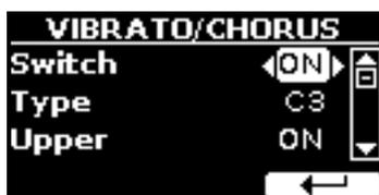
3. Usare i bottoni [▲], [▼] per selezionare il parametro ed usare la manipola [DATA ENTRY] o i bottoni [◀][▶] per regolare il valore. Vedere "Spostare il cursore ed impostare i valori dei parametri" (p. 17).
