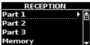
È possibile configurare i parametri relativi alla ricezione MIDI della parte Part 1, Part 2 e Part3. Inoltre, è possibile gestire i messaggi MIDI ricevuti per le memorie e i controlli dell'organo (tonewheel).
